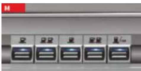
Программируемые кнопки пролива на автоматической версии
